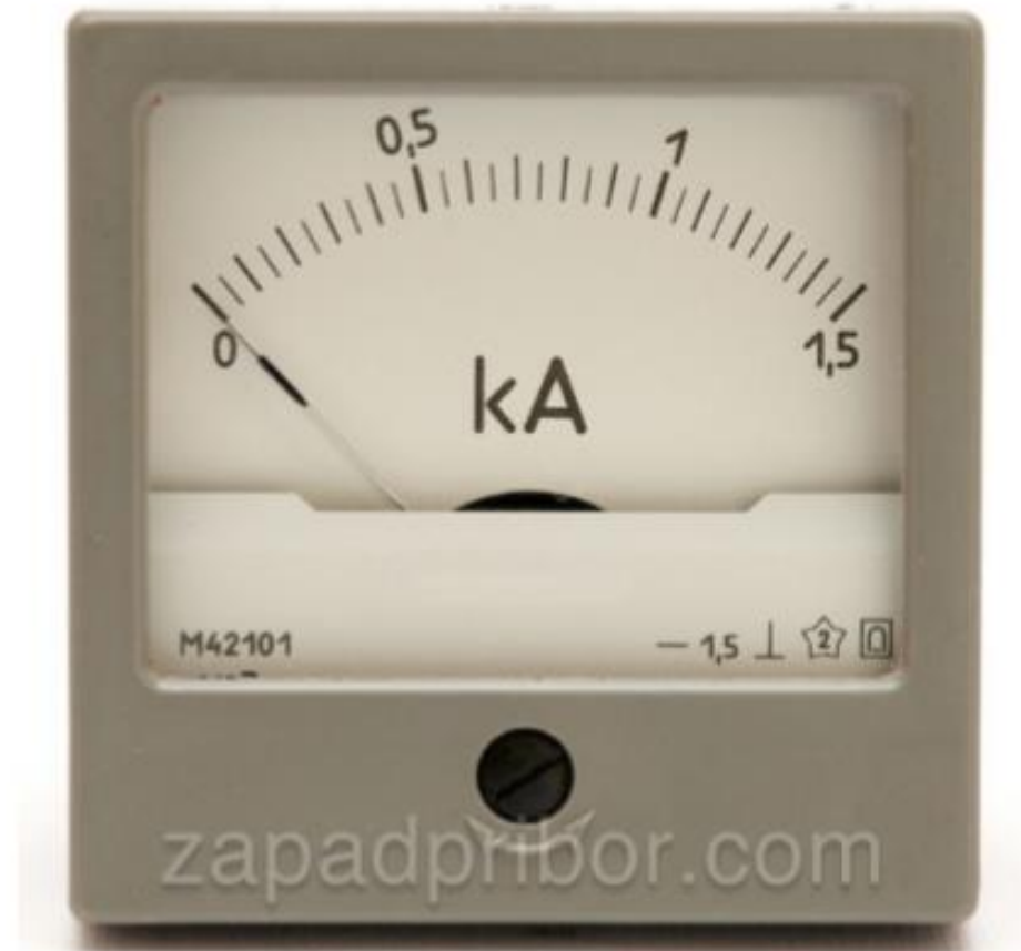
Мал. 2. Кілоамперметр магнітоелектричної системи
